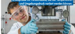
Druckpresse mit Versuchszelle, bei der Temperaturen und Umgebungsdruck variiert werden können.
