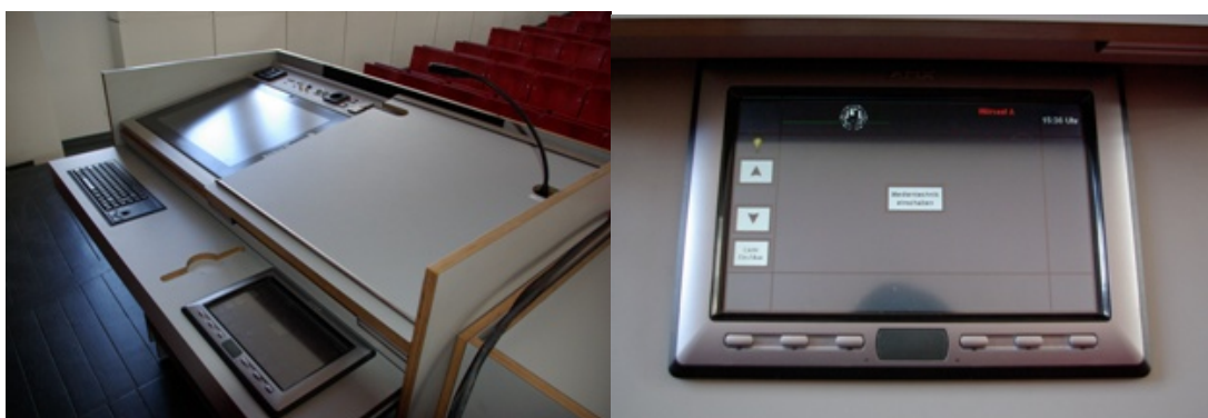
Rednerpult mit Pen-Display, PC-Tastatur und AMX- Mediensteuerung
