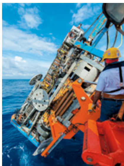
Глубоководная буровая установка MARUM-MeBo | Фото: Т. Клейн, MARUM, Университет Бремена
