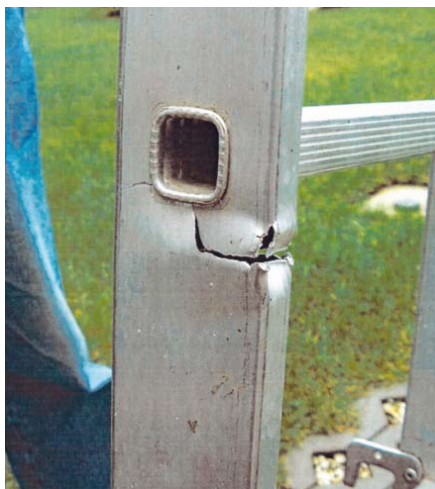
Bild 51: Stark beschädigte Leiter
