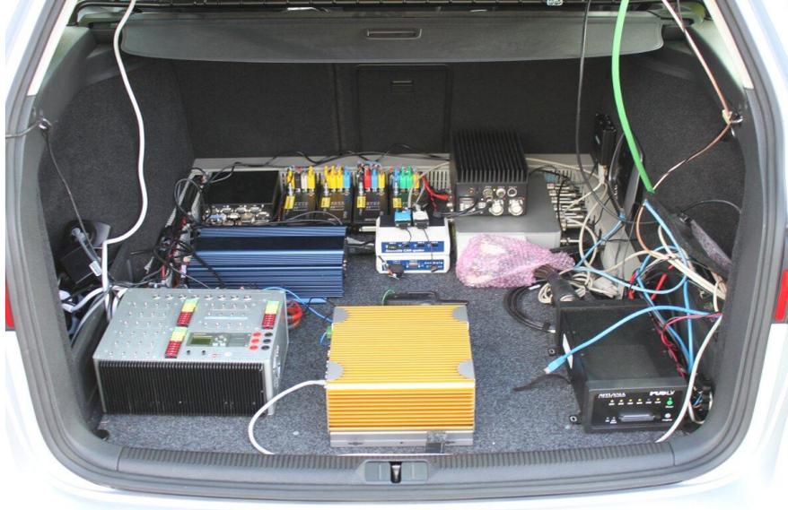
Die Elektronik von *MadeInGermany* im Kofferraum. Zu sehen sind: GPS-Modul (links unten), Embedded Computer für Bildverarbeitung (mitte), Schalteinheit (rechts unten).
