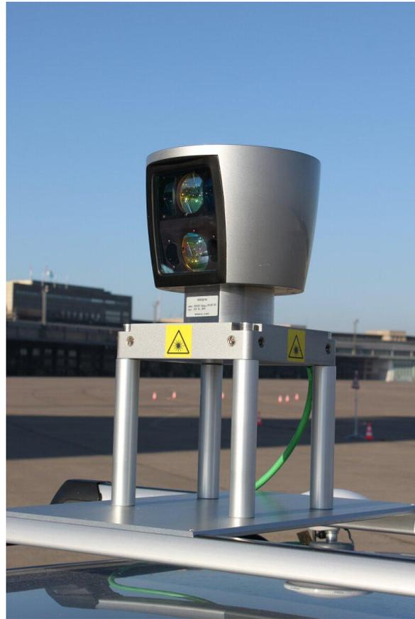
Rotierender Laser mit 64 Strahlen (LIDAR). Ein LIDAR misst die Position zu Objekten durch die Ermittlung der Flugzeit eines Laserstrahls.
