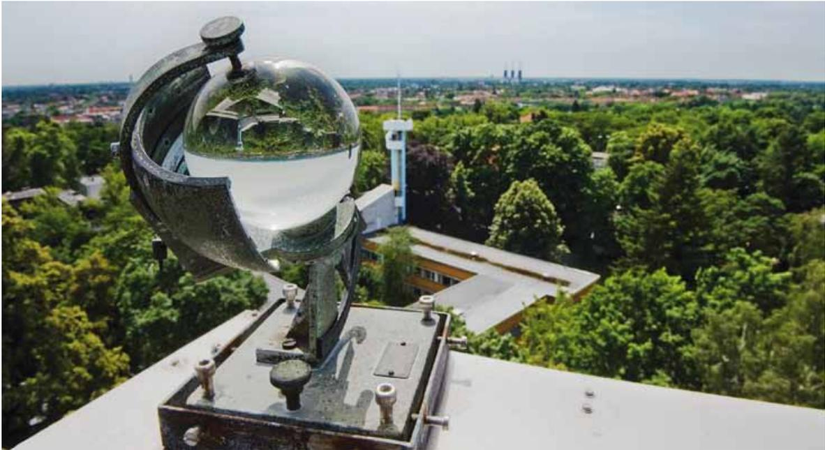
Ein Relikt aus vergangenen Tagen der Wettermessung: Der Sonnenschein-Autograph. Die Glaskugel bündelte die Sonnenstrahlen auf ein Papier, das wiederum in der Metallhalterung angebracht wurde. Dadurch entstand eine „Brenn-Spur“ auf dem Papier, mit der der zeitliche Verlauf der Sonne aufgezeichnet werden konnte.
